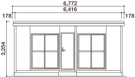
居住用鉄鋼系連棟ハウス ジュネス 2035寸法図
